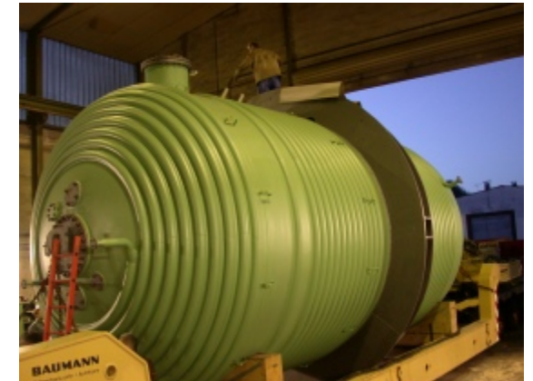
Fa. Tecnimont Destillationsbehälter mit Halbrohr \text{Ø} 60,3 \times 3 Werkstoff= P355NH \text{Ø}=4.000 / L= 8.880 / \text{kg}= 32.900
