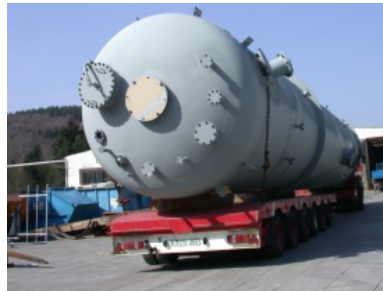
Fa. Tecnimont Werkstoff= P355NH \text{Ø}=3.000 / L= 17.080 / \text{kg}= 24.000
