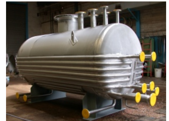
Fa. Bayer Halbrohr \text{Ø} 60,3 \times 3 Werkstoff= 1.4571 \text{Ø}=1.400 / L= 3.200 / \text{kg}= 1.300
