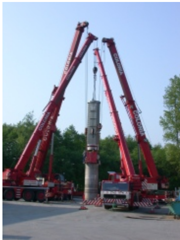
Fa. BASF Werkstoff= 1.4571 \text{Ø}=1.720 \times 45 / L= 9.238 / \text{kg}= 46.500
